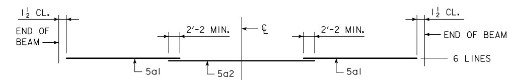
TOP FLANGE LONGITUDINAL BAR LAYOUT
