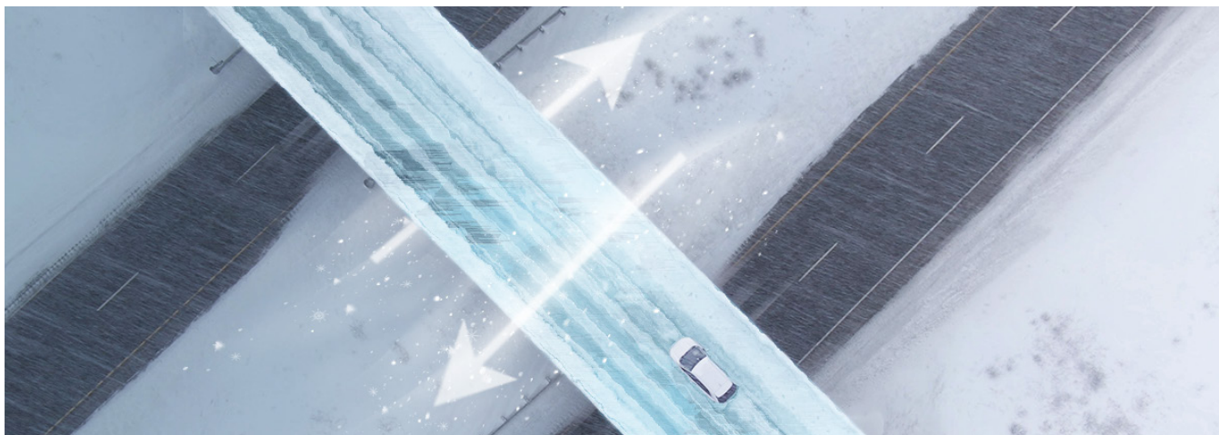
Figura 5.9: Akulli formohet fillimisht në ura për shkak të ajrit që qarkullon sipër dhe poshtë sipërfaqes së rrugës.
